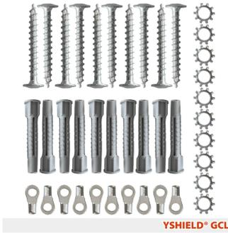
**Erdungsset für unsere Magnetfeld Schirmfolie MCL61.** Die Oberfläche von MCL61 ist elektrisch isoliert. Die Zahnscheiben durchbohren beim Verschrauben des Kabelschuhs die Polyesterfolie und sorgen so für elektrischen Kontakt.
