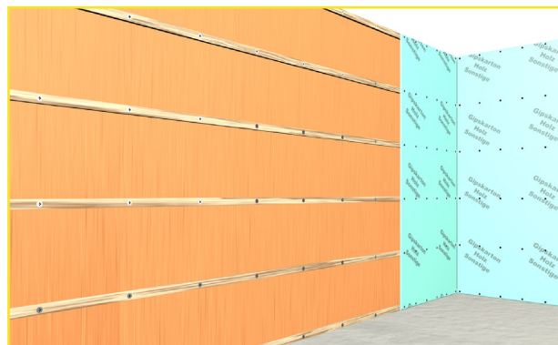
Abb. 16: Fixe Befestigung der Bahnen mit Hilfe der Belattung - Entfernen der Hilfsbefestigung
